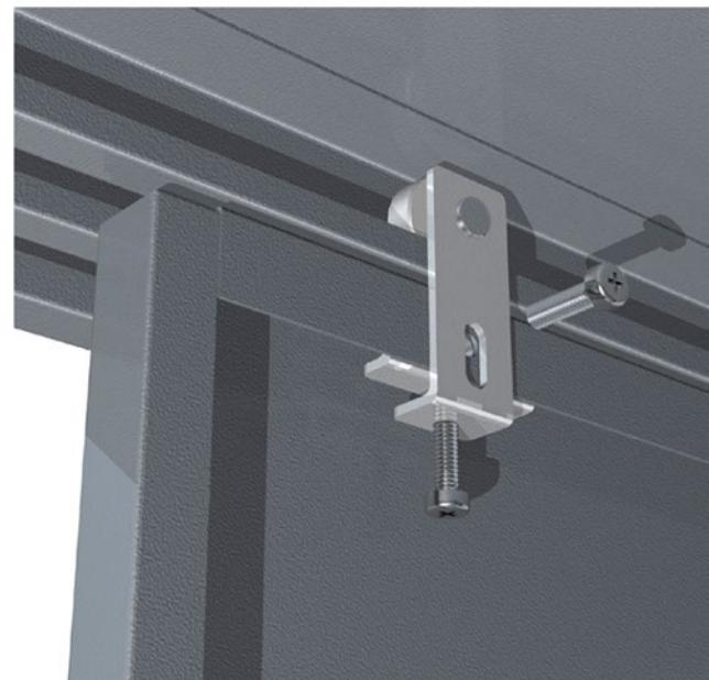
16. Сдвинуть дверь до упора вправо и аналогичным образом установить левый ролик.
