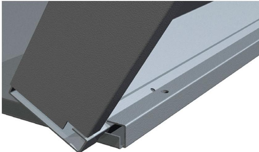
3. Прикрепить дно к задним стенкам с помощью четырех саморезов.
