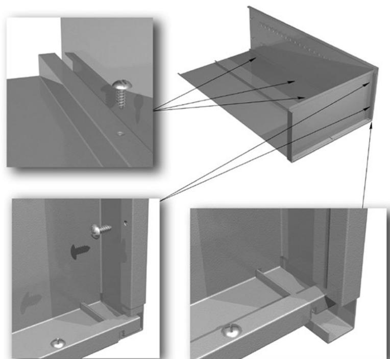
5. Прикрепить боковую стенку к дну с помощью двух саморезов и к задней стенке - с помощью трех саморезов.
