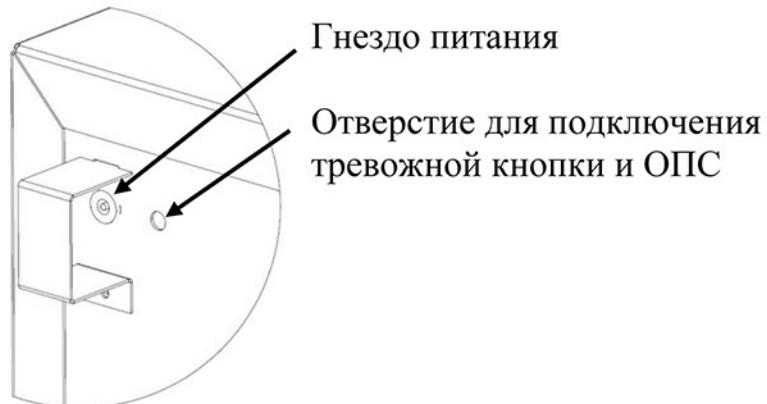
Рис.2 Расположение гнезда питания и отверстия для подключения тревожной кнопки и ОПС.
