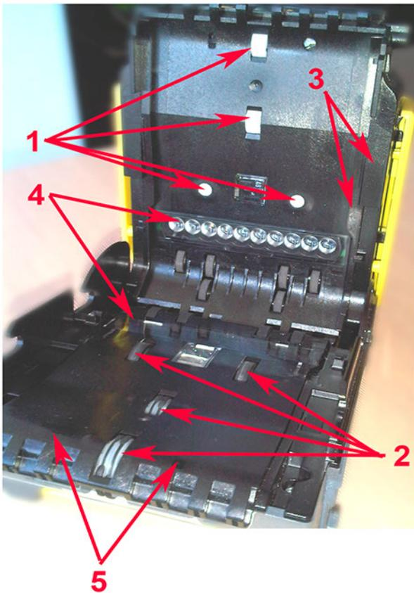
1. Ролики транспортного механизма
