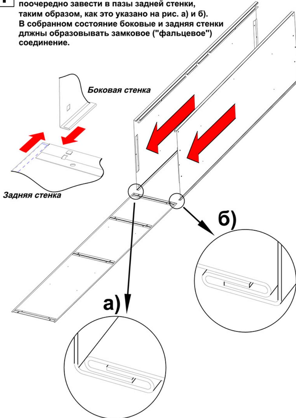
**2** При установке дна и крышки на корпусе необходимо обеспечить совпадение выступов в углах боковых стенок с прямоугольными отверстиями выполненными на сгибе крышки и дна. При установке крышки и дна их боковые загибы должны быть размещены между внутренней поверхностью боковых и задних стенок и фиксирующими элементами. Установленные крышка и дно необходимо зафиксировать, отогнув упомянутые выступы изнутри.
